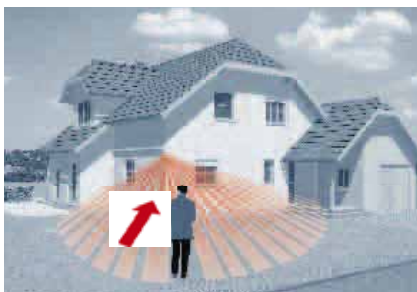
Радиално отчитане – движение директно към сензора (намалено отчитане към номиналния диапазон на действие)
