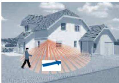
Тангенциално отчитане – движение напречно към сензора (номинален диапазон на действие)
